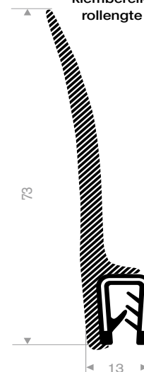
245.00.877 pvc + mosrubber klembereik 1-2 mm rollengte 10 meter
